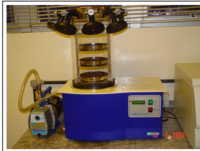
**Figura 16:** Liofilizador modelo L101 (marca - Liotop).
