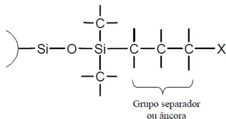
**Figura 12:** Estrutura de uma fase ligada à sílica. X =  $\emptyset$ , OH, CN, NH<sub>2</sub>, C<sub>8</sub>, C<sub>18</sub> ou C<sub>30</sub> (ROSA, 2005).
