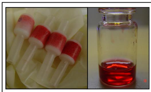
**Figura 19:** Cartuchos Sep-Pak C<sub>18</sub> com antocianinas adsorvidas e concentrado obtido após a eluição.
