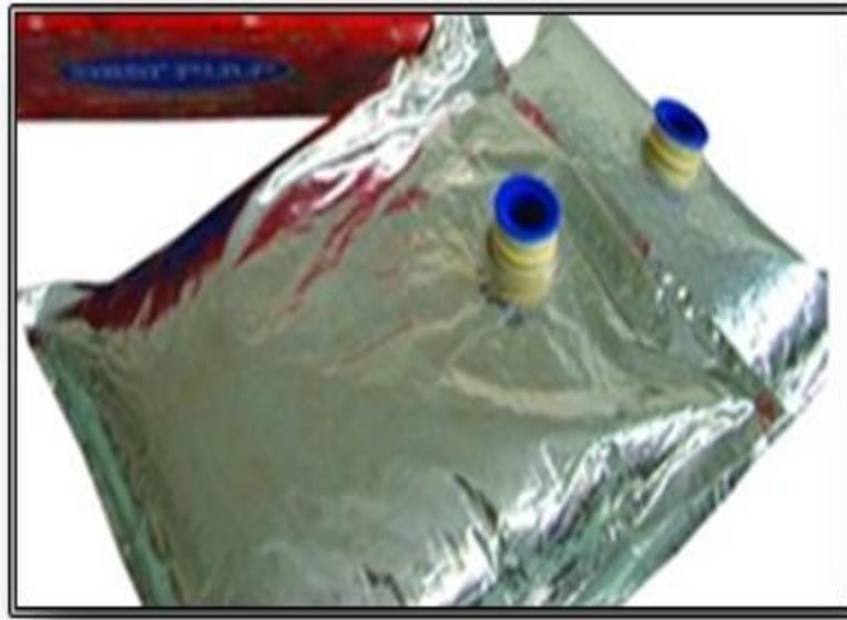
**Figura 13:** Polpa de tomate acondicionada à vácuo em *bags* de alumínio.
