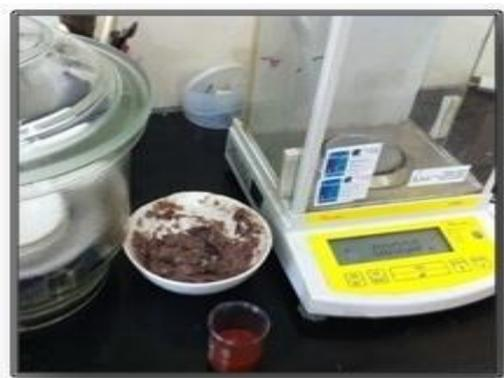
**Figura 26:** Análise de umidade da sardinha eviscerada e da polpa de tomate
