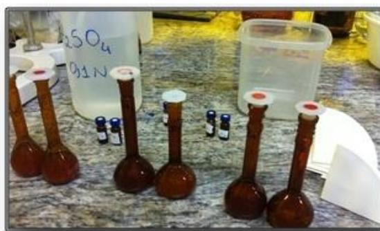
**Figura 27:** Material utilizado para a análise de ácido ascórbico.
