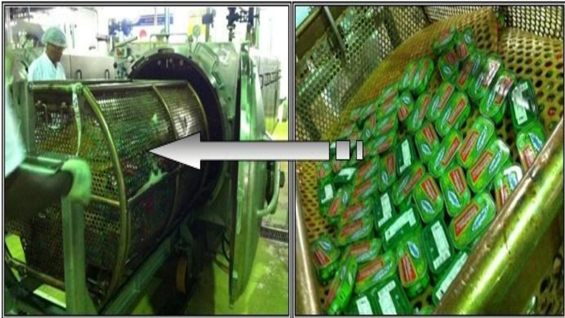
**Figura 21:** Vista frontal do acondicionamento das latas no autoclave industrial.
