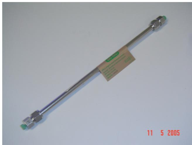
**Figura 26:** Coluna analítica BioRad Aminex HPX87H.
