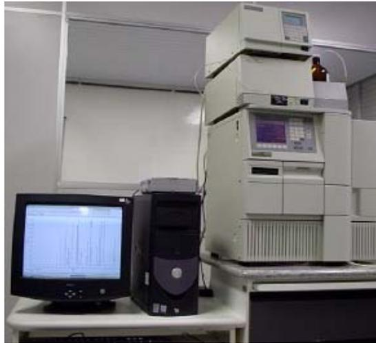
**Figura 25:** Sistema Cromatográfico Waters Alliance 2695, utilizado no desenvolvimento e nas análises do método de Determinação do teor de vitamina C em vegetais.
