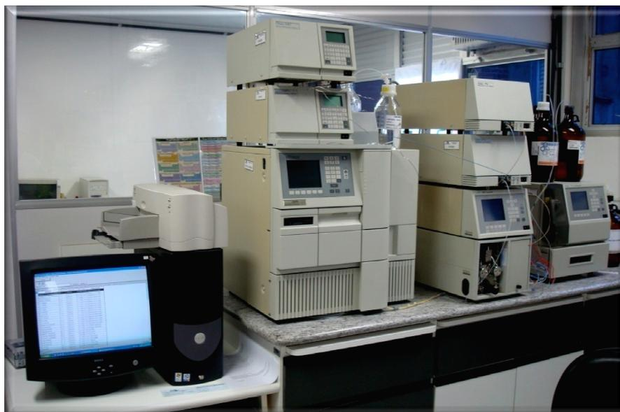
**Figura 19** – Sistema cromatográfico modular (direita), sistema cromatográfico Alliance® (centro) e sistema de aquisição de dados com *software* Empower®.
