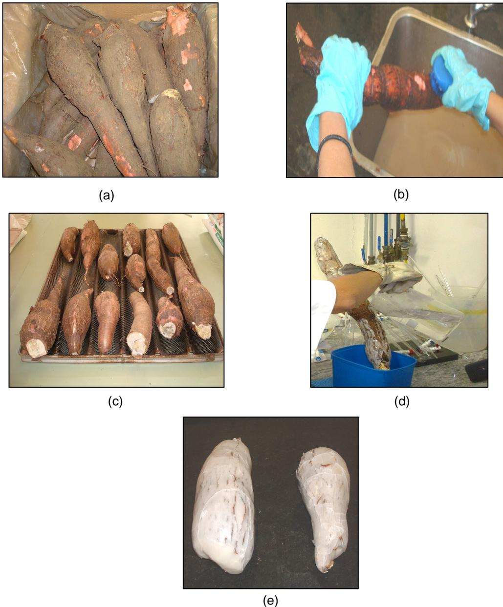
**Figura 9:** Esquema do processo de parafinação: (a) raízes de mandioca com terra; (b) lavagem das raízes de mandioca; (c) secagem; (d) parafinação; (e) raízes de mandioca parafinadas.
