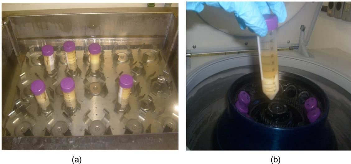
**Figura 14:** Etapas do processo de digestão *in vitro*: (a) amostras em banho-maria a 37 °C com agitador orbital gyromax TM simulando os movimentos peristálticos do organismo à temperatura corpórea; (b) separação da fração micelar por centrifugação.
