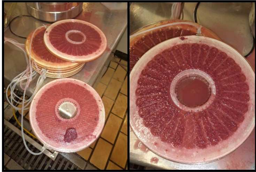
Figura 5.1. Entupimento das membranas do sistema de microfiltração ocasionado pela passagem do suco integral de romã
