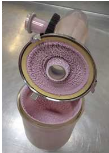
Figura 5.6. Produto em pó obtido a partir do processo de microencapsulação do suco de romã em spray dryer
