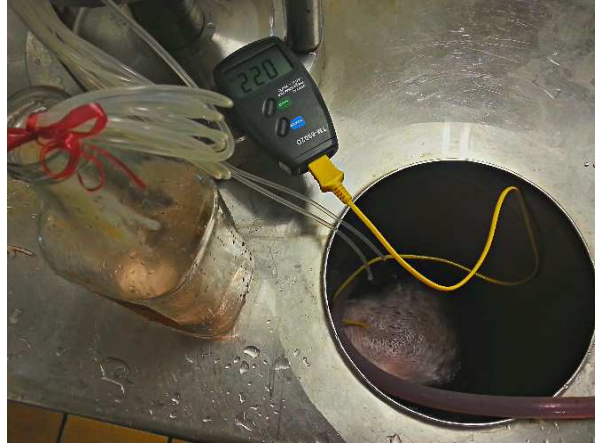
Figura 5.10. Processo de osmose inversa do suco de romã previamente microfiltrado.
