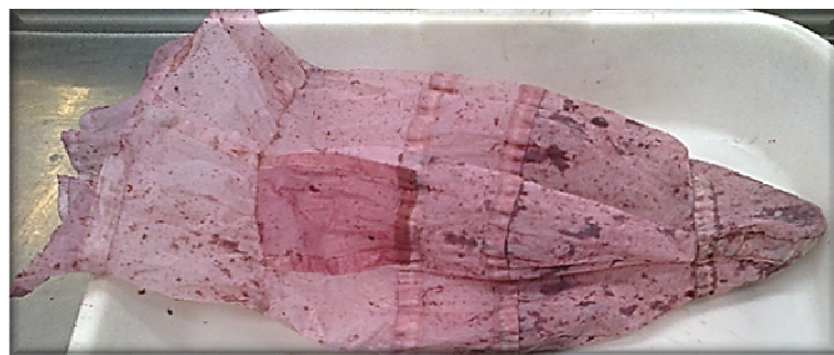
Figura 4.4. Malha de 150 \mu\text{m} utilizada na etapa de filtração
