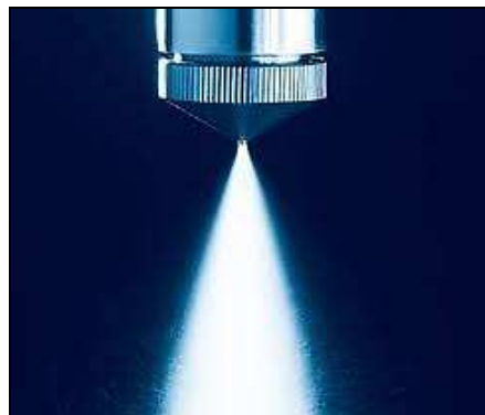
Figura 3.15. Bico atomizador. Fonte: http://imk209.wikispaces.com/CJW--+Chapter+4
