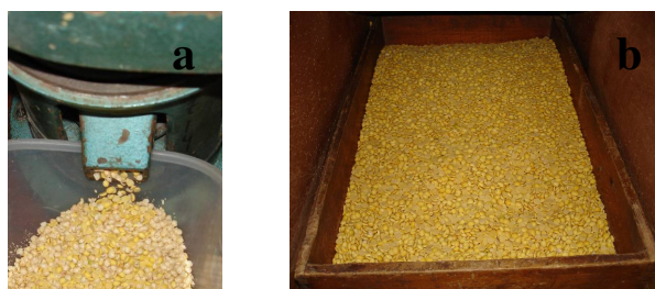
Figura 7. Descascamento da soja (a) e germe peneirado (b)
